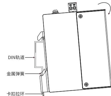
2. 将交换机迅速旋转按入DIN导轨，如下图所示位置。（若按压困难，也可先拉开拉环再将交换机按入DIN导轨。）
